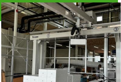
↑れんこんパークに新たに導入された自動米投入機（上）と仕分けロボット（下） これらの作業が全て機械化されたことで、人員の適正配置に繋がっている。
